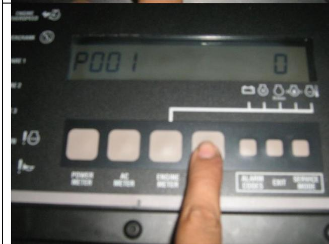
Una vez se ingresa al parámetro de programación se encuentran los puntos detallados en los tópicos anteriores. Desplazarse con las teclas de navegación hacia arriba o hacia abajo para llegar a los parámetros de programación deseados.
