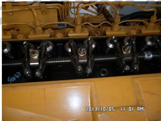
**Calibración de válvulas**
