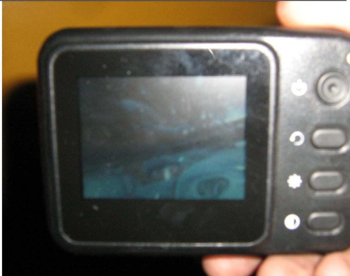
**Análisis con borescopio, se analiza internamente el entrehierro del alternador principal, el cual se encuentra dentro de las tolerancias especificadas por fábrica.**
