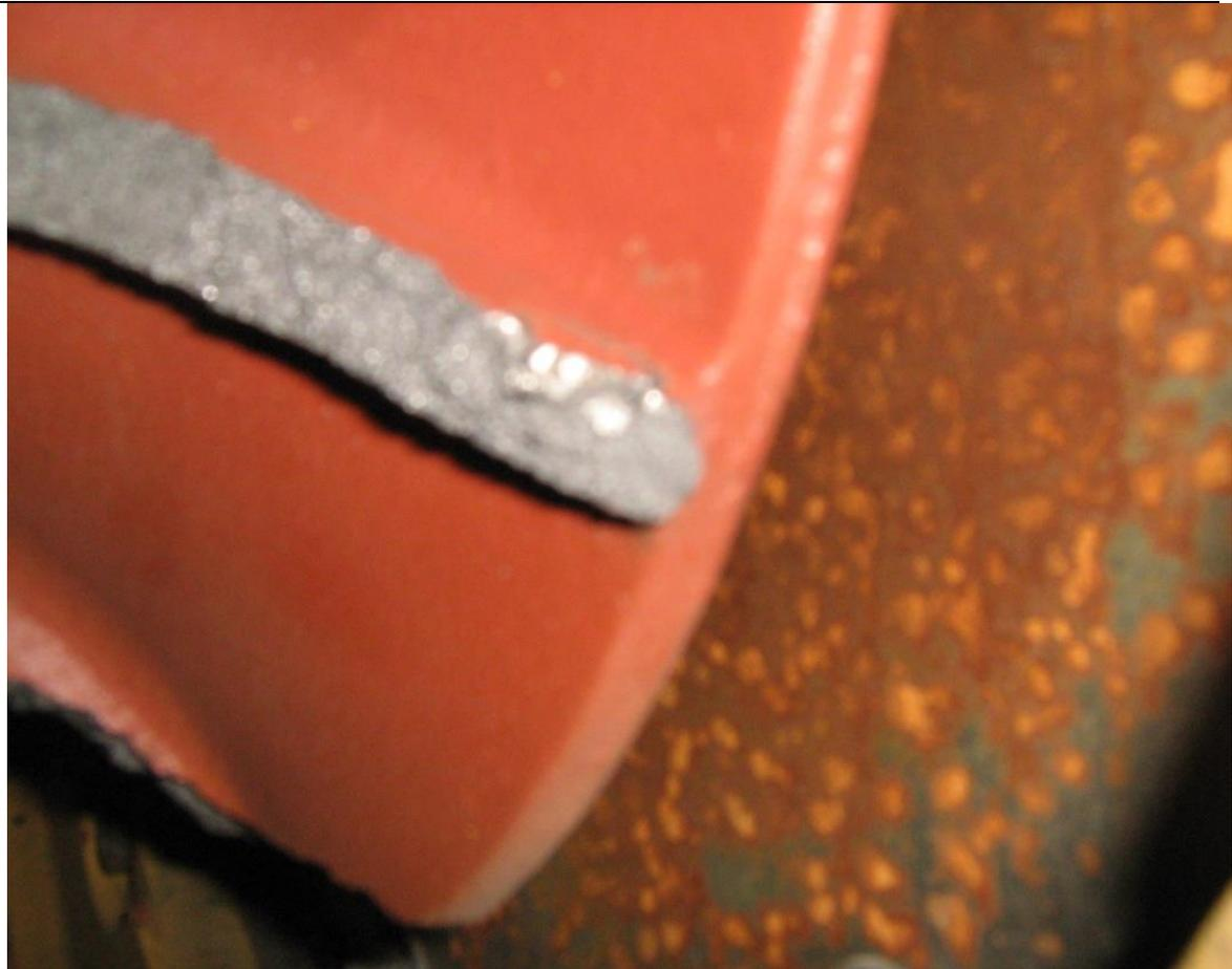
**Ventilador del alternador completamente destruido.**
