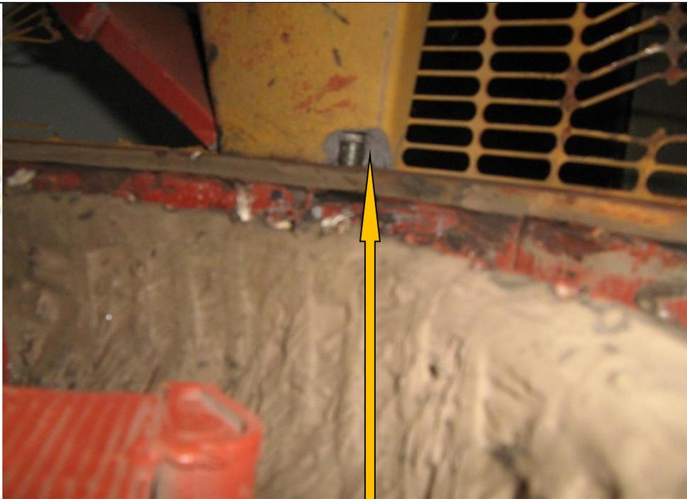
Imagen de ruptura de tornillo de escudo causado por la vibración del equipo en el momento en que colapsa por completo el ventilador,
