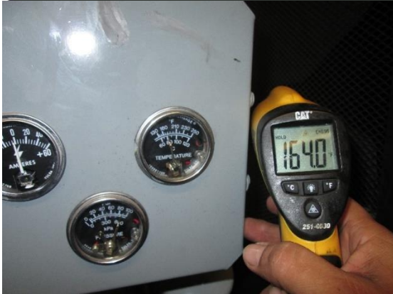
Comparación de valores de temperatura del equipo entre el Instrumento análogo y el termómetro infrarrojo
