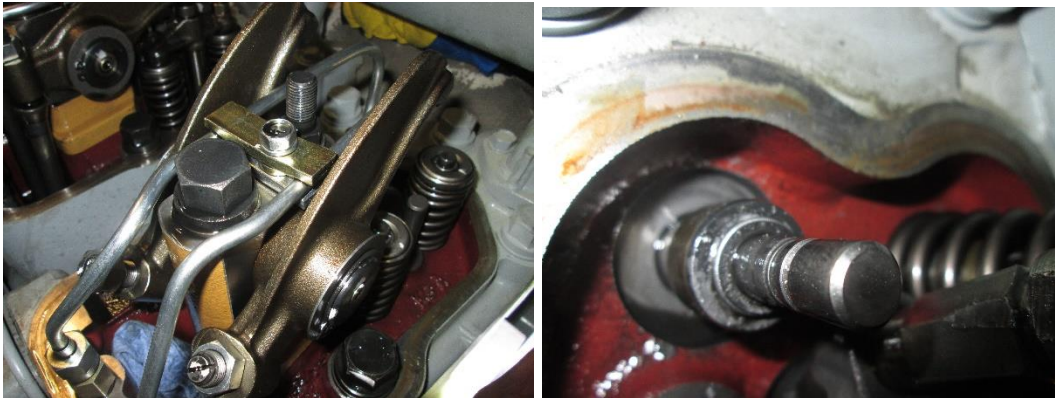
La válvula sufrió rotura en la cabeza, el vástago quedó suelto.
