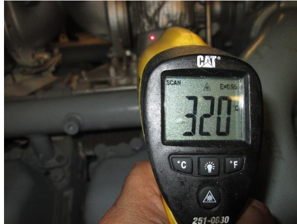
Toma de magnitudes físicas, temperatura del turbo
