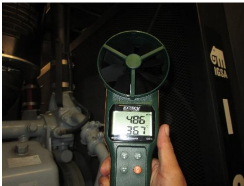
Análisis de flujo de aire en el cuarto del equipo
