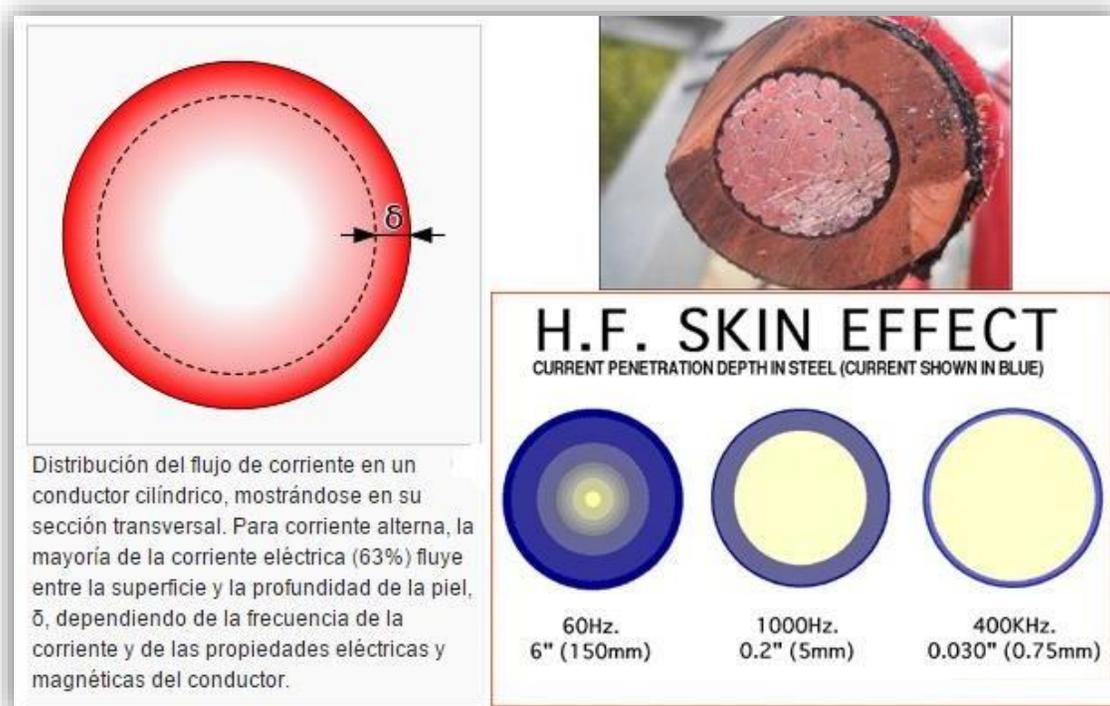
EN LA FOTOGRAFÍA: distribución de flujo En frecuencias altas los electrones tienden a circular por la zona más externa del conductor, en forma de corona, en vez de hacerlo por toda su sección, con lo que, de hecho, disminuye la sección efectiva por la que circulan estos electrones aumentando la resistencia del conductor.
